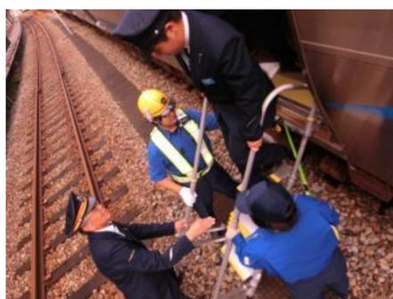
【施設係員による応急措置器の取り付け訓練】
