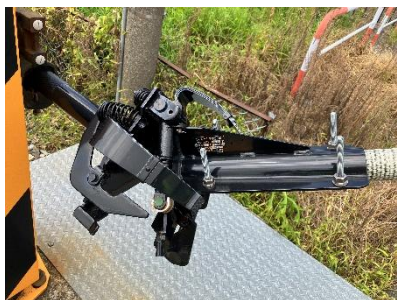
・遮断かん折損防止器
