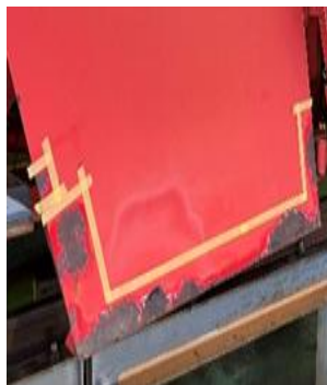
・除雪車両 経年によるさびが発生
